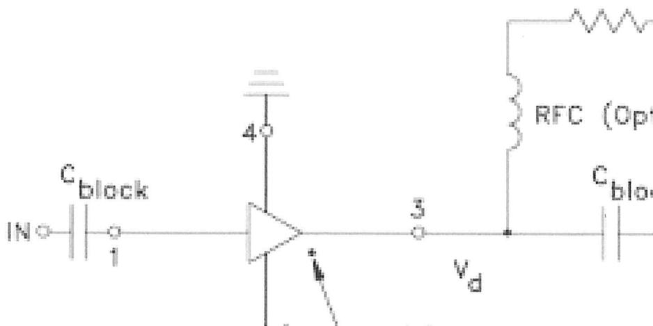
Dimensiona la resistenza di polarizzazione per fare lavorare l'amplificatore nel suo punto di lavoro con  $I=60\text{mA}$  e  $V_d=2.5\text{V}$  sapendo che  $V_{cc}=5\text{V}$  (trascura la resistenza serie dell'induttanza RFC). Calcola la potenza assorbita dall'amplificatore e quella erogata dall'alimentatore.
